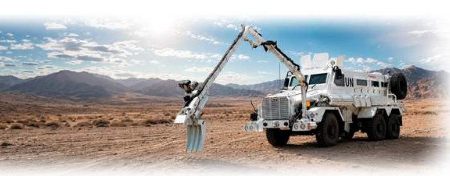
VÉHICULE PROTÉGÉ CONTRE LES MINES, VERSION 6X6 AVEC BRAS D'INSPECTION
